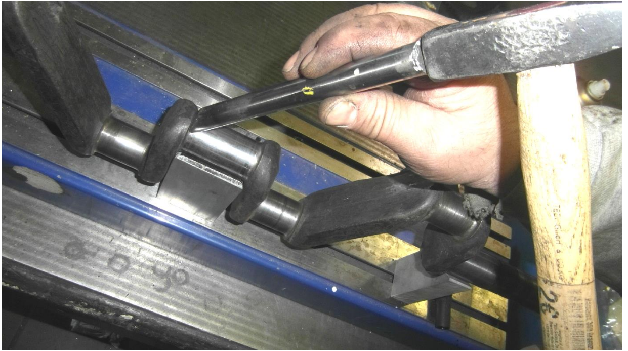
Bild 7: Dengeln mit dem Meißelwerkzeug ohne Schneide, sondern Radius 2 mm
