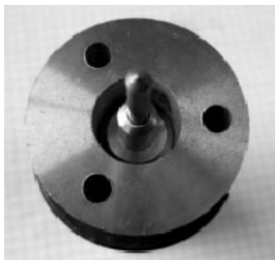
Lieferzustand mit 16,5er Bohrung
