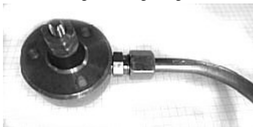
Abwandelte Variante mit geradem Nippel Innen-Ø 22,5 mm und 8 mm Rohr
