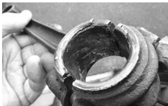
Pleuel mit geschmolzenem Lagermetall
