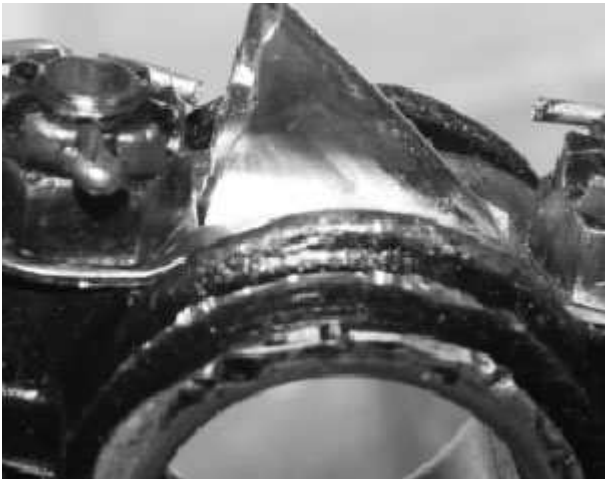
Ölschöpfer montiert an die Pleuel-Lagerschale
