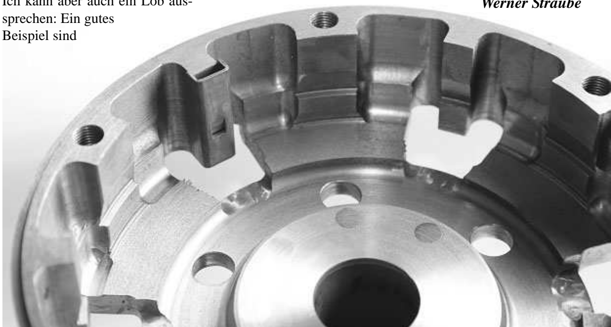
Getriebetrommel: Ein lug shoe angesetzt zum Montieren mit Hammerschlag.
