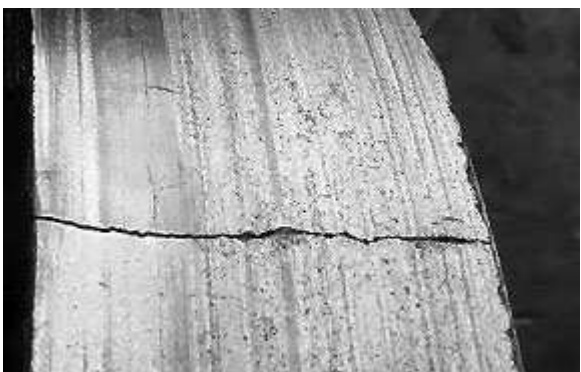
Scharfkantiger Riss in der Trommel
